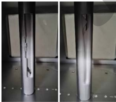
图 8 剪切拉伸造成的冰层破裂 Fig. 8 Ice fracture resulting from shear tensile 和外圆柱接触的上端或者下端区域。主要是在剪切拉伸过程中,冰在这两个区域很容易发生应力集中现象,所以出现了局部的破裂,相应的,这种物理现象在图 7 中的剥离力时间历程曲线中出现
